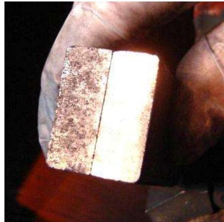
Внешний вид: неравномерное обгорание скользящей поверхности щетки. Проблема: неравномерное нажатие на щетку, перегрузка. Меры по устраниению: техническое обслуживание.
