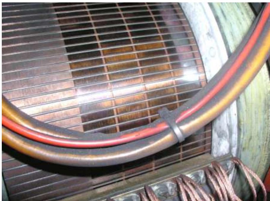
Внешний вид: неравномерное, пятнистое, образование окисной пленки, повышенный износ щеток.
