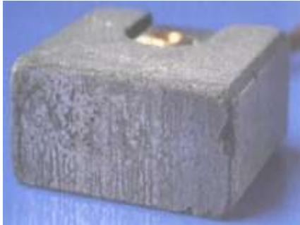
Внешний вид: образование кратеров на контактной поверхности щетки.
