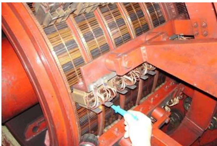
Внешний вид: следы от ожогов на чередующихся частях коллектора. Проблема: затруднения в коммутации, искрение щеток, неисправность обмотки. Меры по устраниению: возможно замена щеток на тип "сэндвич" и на тип с большим свойством самоочищения.
