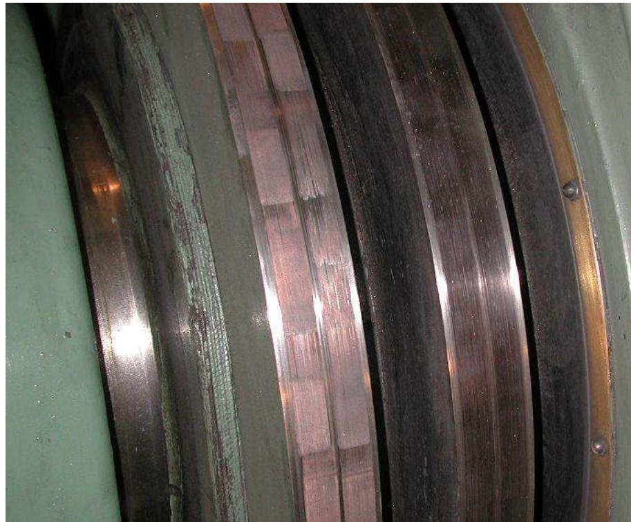
Внешний вид: коррозионные пятна соответствующие размеру контактной поверхности щеток.
