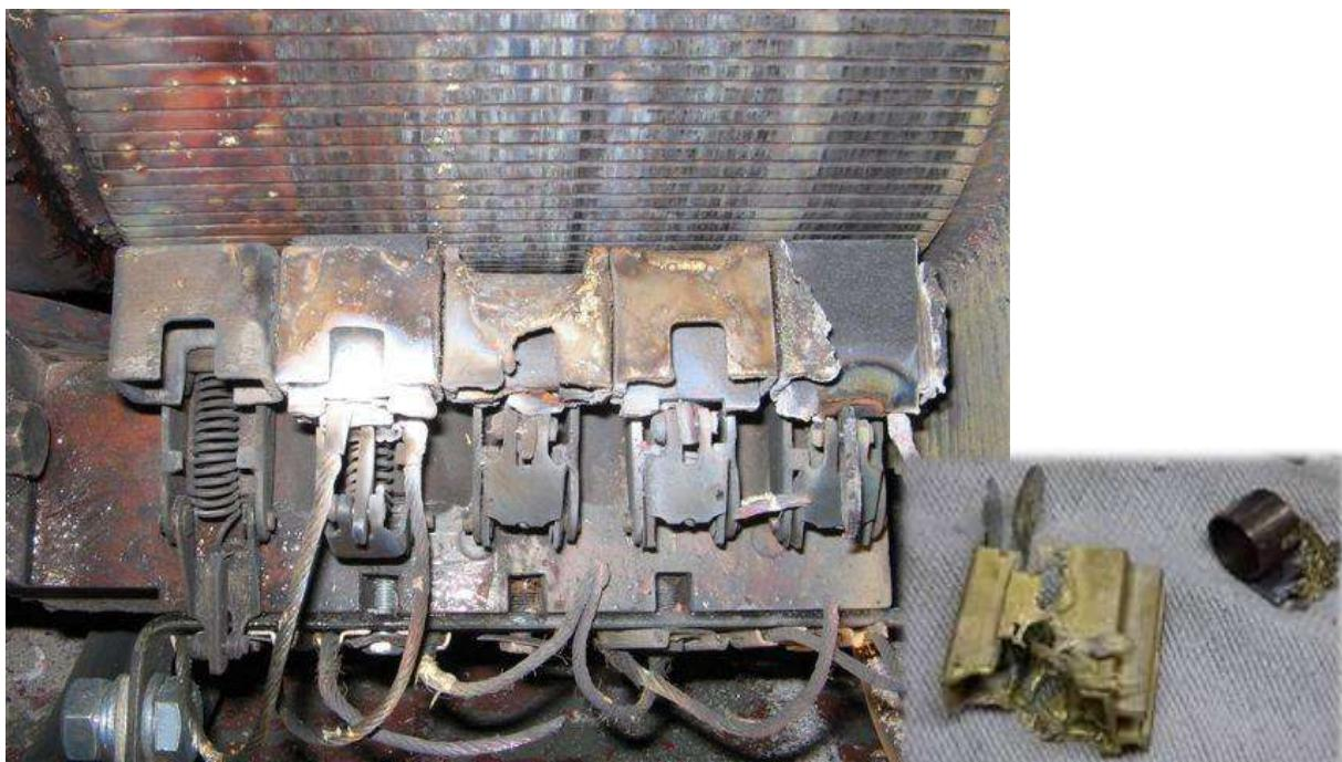
Внешний вид: разрушение щеткодержателей, повреждение коллектора.
