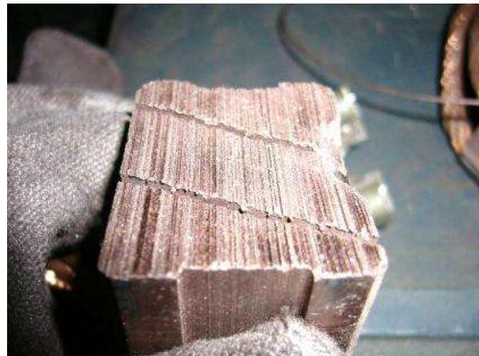
Внешний вид: образование канавок на скользящей поверхности щеток, образование борозд.
