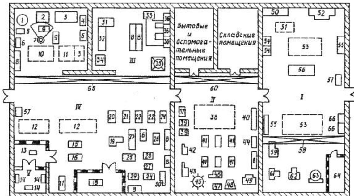
Рис. 12. Типовая схема расположения оборудования в цехе по ремонту электрических машин:
