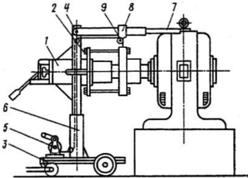
Рис. 4. Гидравлический съемник для снятия полумуфт:
