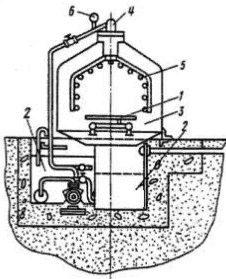
Рис. 1. Установка струйного типа для мойки деталей:
