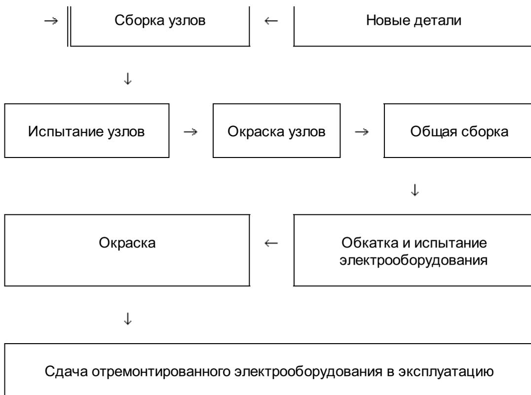
Общая схема технологического процесса ремонта электрического оборудования
