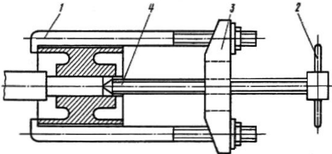
Рис. 5. Винтовой съемник:
