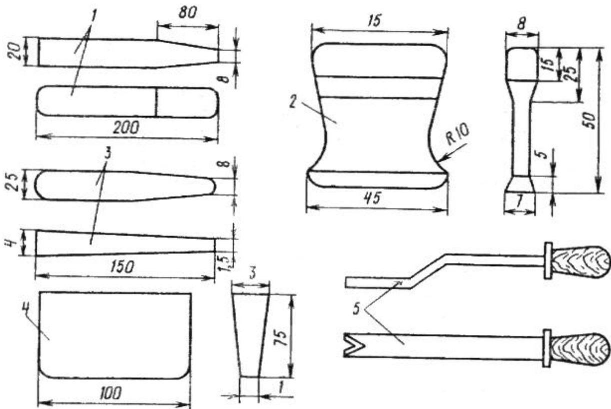
Рис. 6. Набор инструмента обмотчика:
