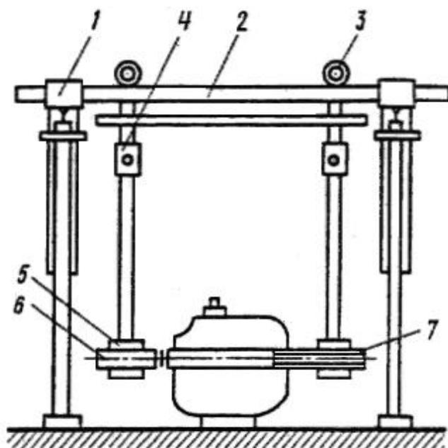
Рис. 3. Приспособление для извлечения ротора из статора электродвигателя:
