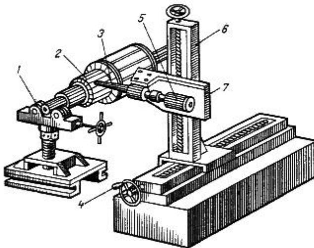
Рис 10. Фрезерный станок для продорожки коллектора:
